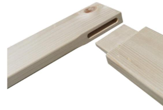
Konstrukce výrobku je spojením dřeva do dřeva pomocí drážky. Na spojení horního rámu a nosných hranolů používáme staré technologie čepu a dlažu, popř. spojení do drážky bez použití vrutů. V celé konstrukci nepoužíváme vruty a žádný spoj není viditelný.
